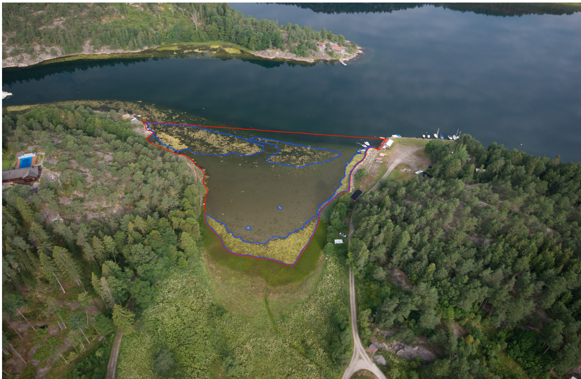
Figur 2. Exempel på ytbereäkningar i bildbehandlingsprogrammet ImageJ. Gränserna för viken som definierat av BVVF är markerade i rött och fintrådiga alger är markerade i blått. Täckningsgraden beräknas som de fintrådiga algernas utbredning delat med vikens totala yta (blå markering / röd markering). Viken är från 2016 års undersökning, tagen innan 90 graders vinkel implementerades.
