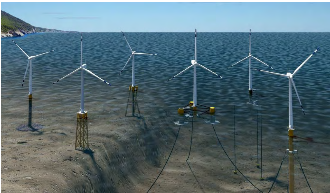
Figur 7. Olika fundamentstyper; från vänster monopile, fackverk, vridet fackverk, flytande halv nedsänkt (semi-submersible), flytande dragbensplattform (tension leg) och flytande stolpboj (spar buoy). Figur från ICF (2020; illustration av Josh Bauer, NREL Department of Energy).
