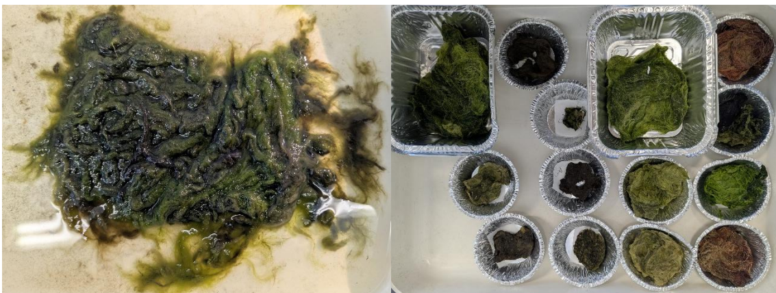
Figur 4. Algprov inför analys i lab med förekomst av både fintrådiga grönalger och fintrådiga brunalger (vänster) samt algprover förberedda för torkning (höger).
